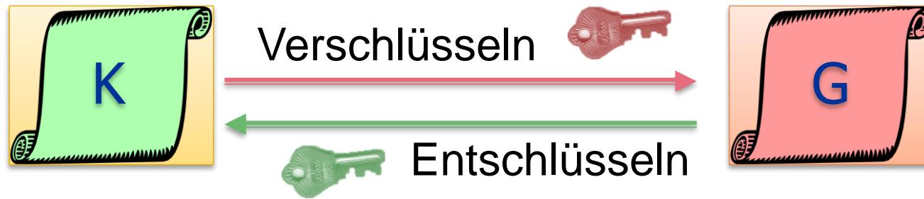
Der Klartext (K) wird mittels eines Schlüssels verschlüsselt.
