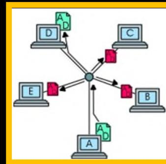
Wird in einem **passiven Sternnetz** ein Paket verschickt, so leitet der Verteiler im Knoten (**Hub**) die Daten an **alle angeschlossenen Computer** weiter.
