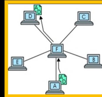
Im aktiven Netz wird die Stelle des Knotens durch eine Recheneinheit (**Switch**) eingenommen. Diese entscheidet, wohin die Daten geleitet werden, so dass nur der Empfänger die Nachricht erhält.
